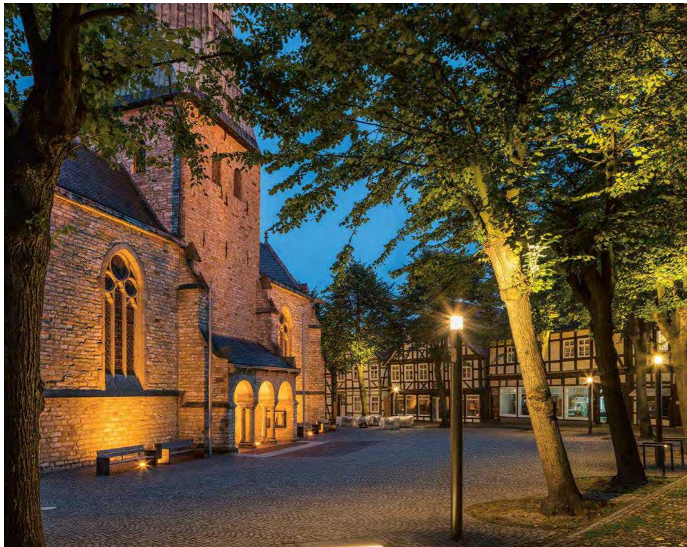
↑ Qualité d'éclairage créée grâce à plusieurs sources lumineuses dans des tons plus chauds, installées à une hauteur inférieure.
