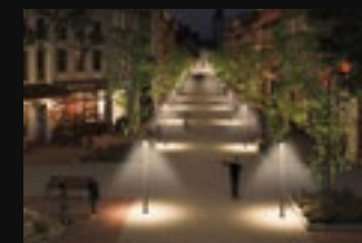
II Am Abend schmale Lichtverteilung und mit reduzierter Lichtintensität.
